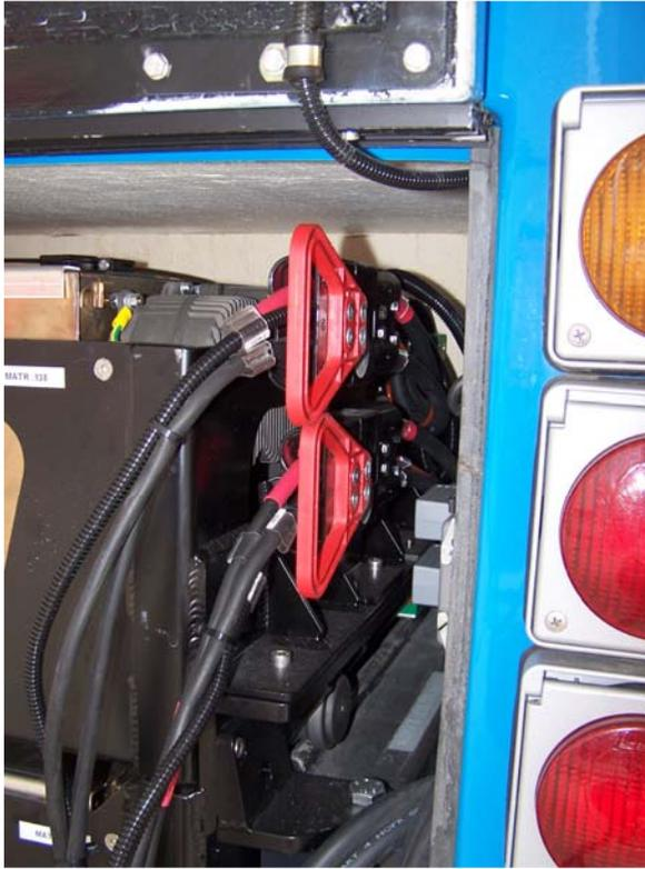
Para cargar las baterías “ZEBRA”, el vehículo dispone de dos conectores (uno por batería) y un tercer conector de toma de datos.
